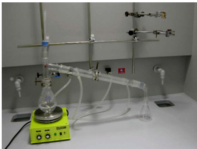
Figura N° 15.2.- Proceso de destilación simple
